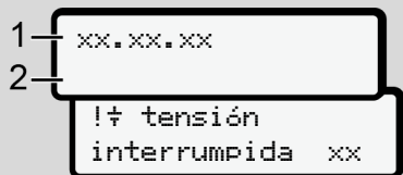
Fig. 132: Indicación – Tensión interrumpida
